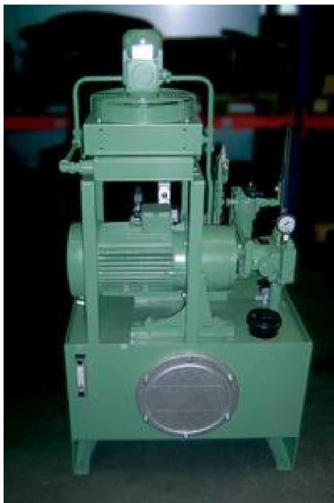
Centrale oleod. per impianto di sollevamento
