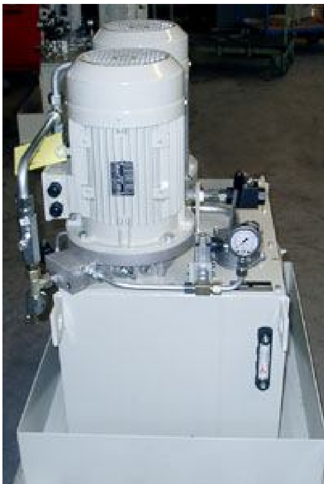
Centrale oleod. per macchine lavorazione legno
